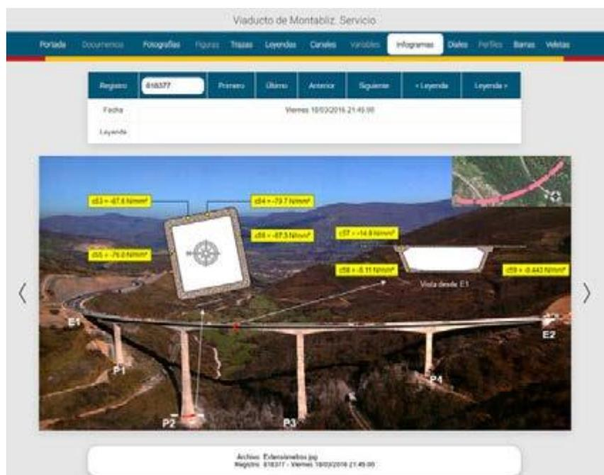
Viaducto de Montabliz: Tensiones en el hormigón en determinadas secciones de control (ejemplo del 18 de marzo de 2016 a las 21:45).
